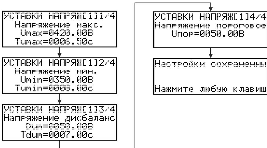
$U_{max}$  - уставка предназначена для срабатывания защитного отключения в случае превышения напряжения на ЭУ. Данная уставка задается на значение максимальное рабочее напряжение ЭУ, а время задается на допустимое кратковременное перенапряжение ЭУ.
